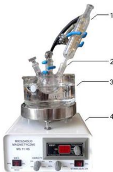
Rys. 9. Aparatura do epoksydacji złożona z: 1) chłodnicy zwrotnej, 2) reaktora szklanego z mieszadłem teflonowym, 3) krystalizatora wypełnionego olejem silikonowym, który pełnił funkcję łaźni olejowej, 4) mieszadła magnetycznego z funkcją grzania i stabilizacją temperatury firmy WIGO MS 11 HS
