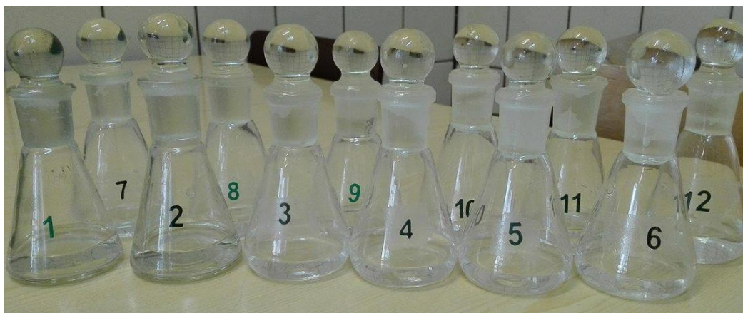
Rys. 5. Skala n -butanolowa wzorców intensywności zapachu Źródło własne.
