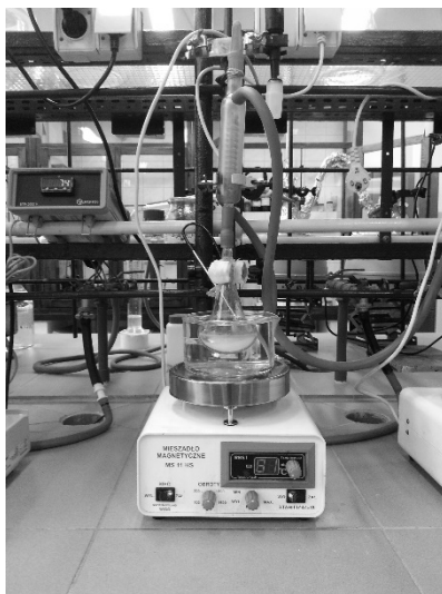
Rys. 2. Zdjęcie aparatury wykonanej do epoksydacji EDA
