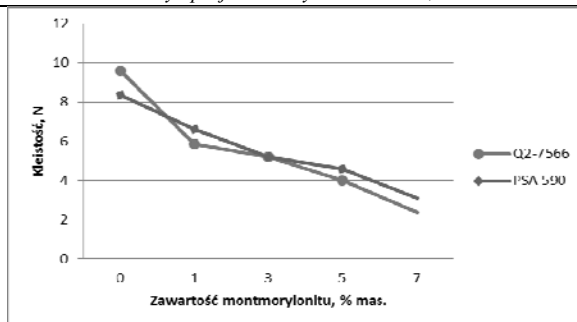
Rys. 2. Kleistość klejów silikonowych przy różnej zawartości montmorylonitu
